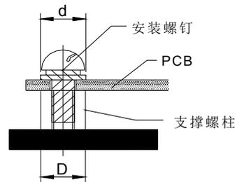
使用M3的螺钉安装, 平垫的直径  $d \leq 7\text{mm}$
